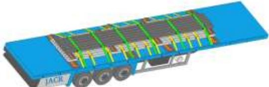
**Materiales de sujeción y cables por sección con 2 capas de carga**
