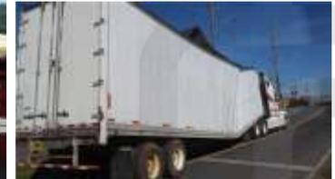
Situar el centro de gravedad (CDG) de la carga según indica el diagrama de carga del vehículo, sin sobrepasar la MMA total y por eje autorizadas.
