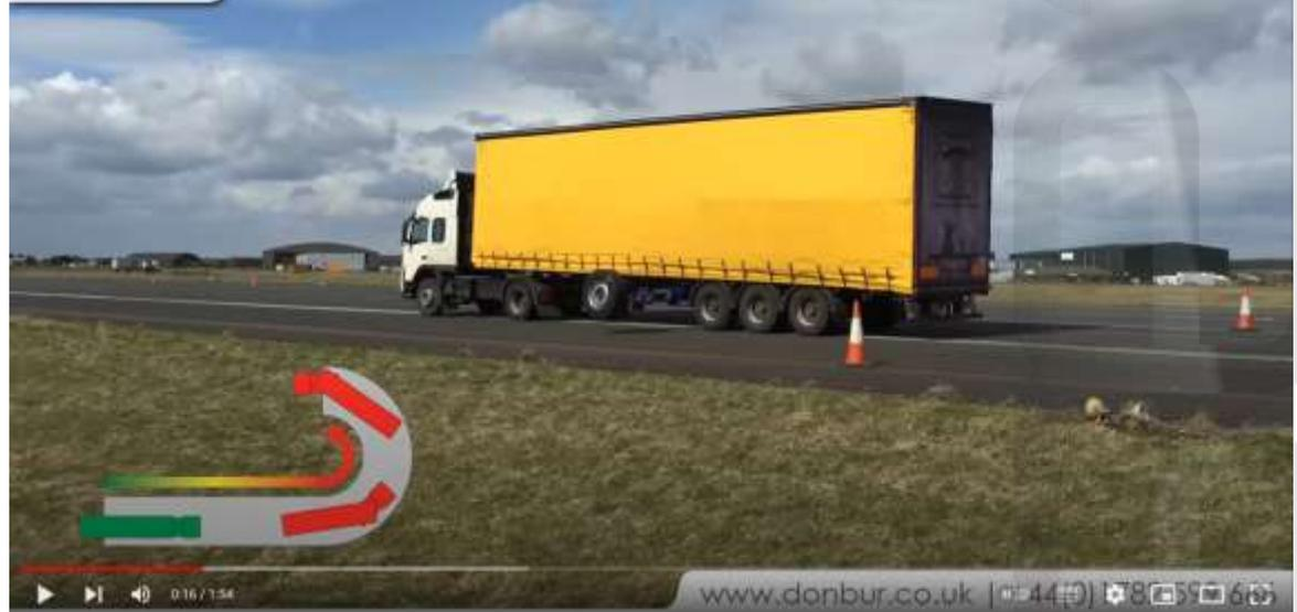
El **test estático** consiste en comprobar la resistencia de las paredes colocando paneles y unas bolsas hinchables entre ellos y la pared del semirremolque. En el **test dinámico** se comprueba la resistencia mediante una prueba de conducción en pista.
