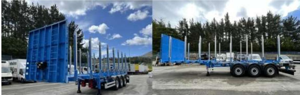
Estaquera CHR H12 - Resistencia máxima de 12 t por estaquera (6 t por estaca)
